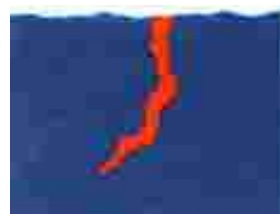
3. Usunięcie Nadmiaru penetranta
